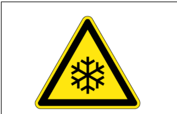
Figura 2 – Rischio di ustioni per gas criogenico
